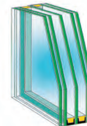
Vetro isolante e di sicurezza da mm 34 (6/7+9+4+9+6/7) per pannello da mm 40
