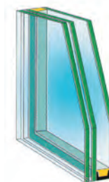
Vetro isolante e di sicurezza da mm 19 (6/7+9+4) per pannello da mm 24
