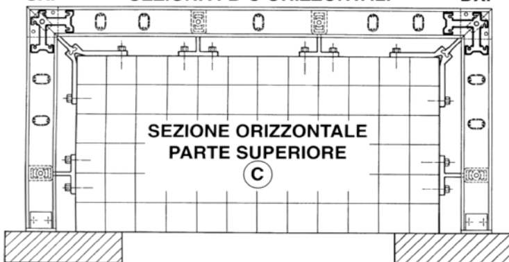
Lavorazioni sul profilo 200591 per fissaggio profilo 800395 coprimontante.
